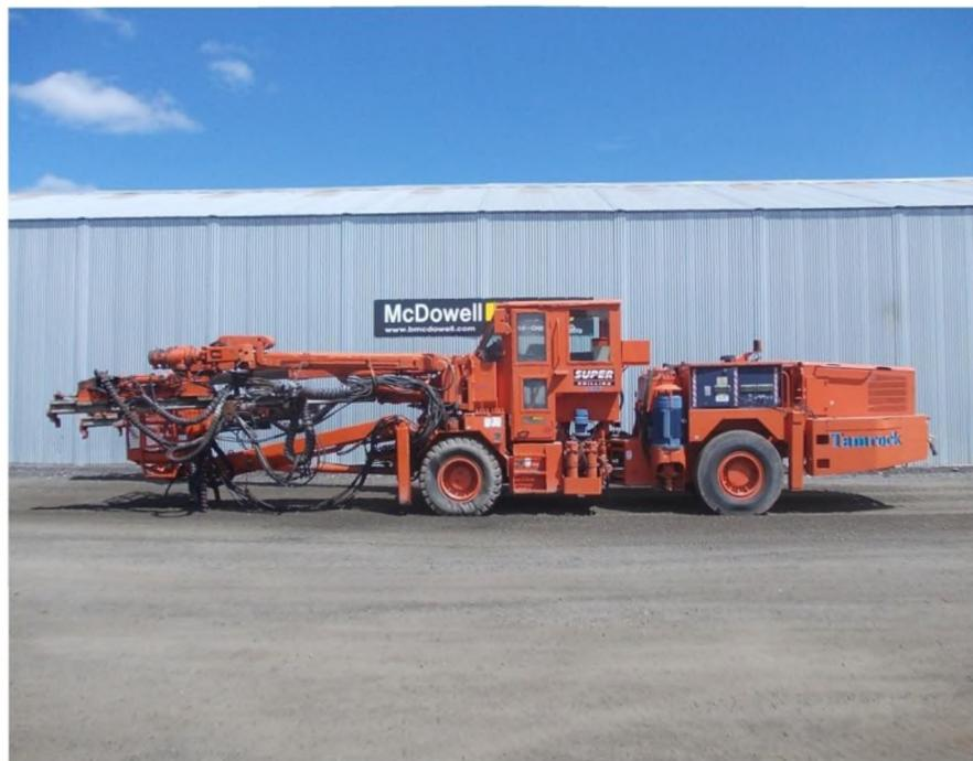
2.2 Сурет – Tamrock SOLO 5-7C бұрғылау машинасы
